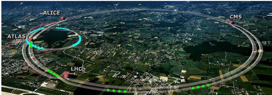
Figure I.2 – Vue aérienne du Large Hadron Collider situé à la frontière franco-suisse : avec schéma des différents accélérateurs et détecteurs de particules enterrés. Le cercle indique l'emplacement où circulent les particules, qui est enterré à une profondeur de 100 m.
